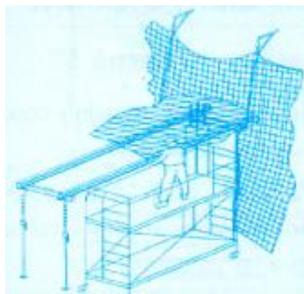
**Detalle:** esquema de colocación "paso 2", redes desechables
