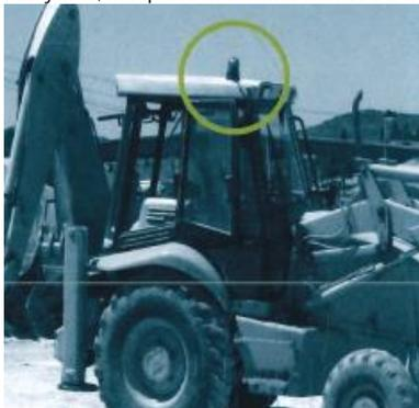
**Detalle:** máquina con dispositivo rotativo.
