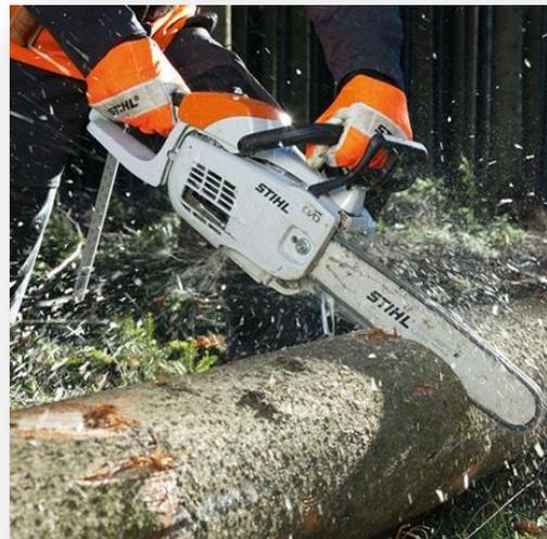
Para su puesta en marcha necesitan como combustible gasolina mezclada con aceite para motor de dos tiempos.
