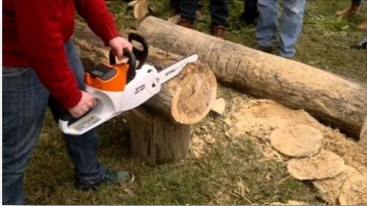
Este tipo de motosierra es sencilla de manejar y tiene la ventaja de que permite autonomía total, al no necesitar estar conectadas a la corriente eléctrica. Su mayor inconveniente, además de mayor peso que la eléctrica con cable, es la corta duración de la batería, por lo
